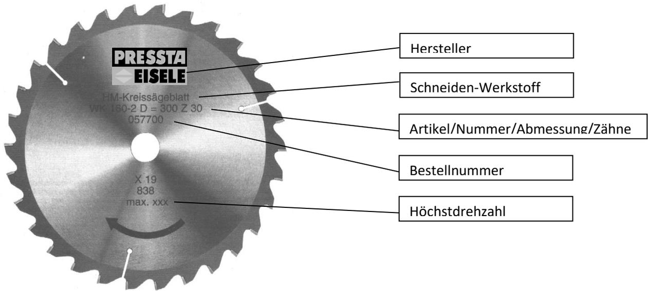
Bild 12.1. Sägeblattbeschriftung
