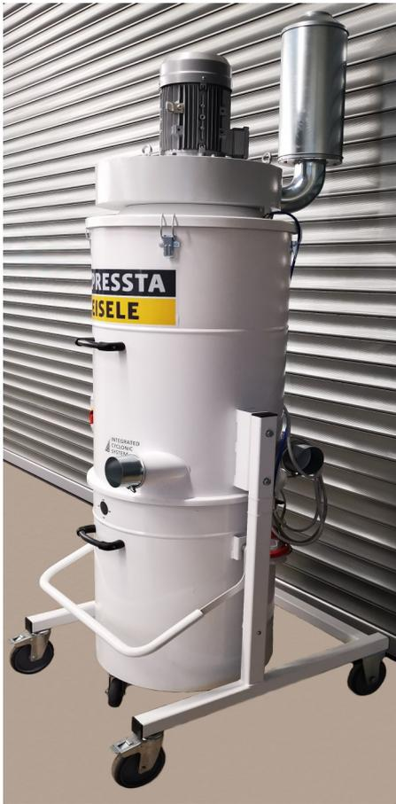
Die mobile Späneabsauganlage **MG3** sammelt Staub und Späne in einem ausklinkbaren und verfahrbaren 172 Liter Behälter.
